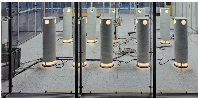
Kabina kontrolna mocy ogrzewania i chłodzenia
