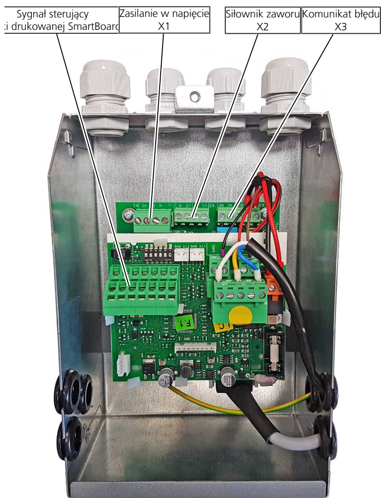
Rys. 27: Płytki ze skrzynką elektryczną
