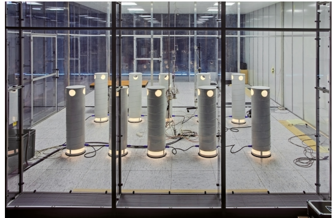
Konfiguracja testowa 10 manekinów sterowanych mocą
