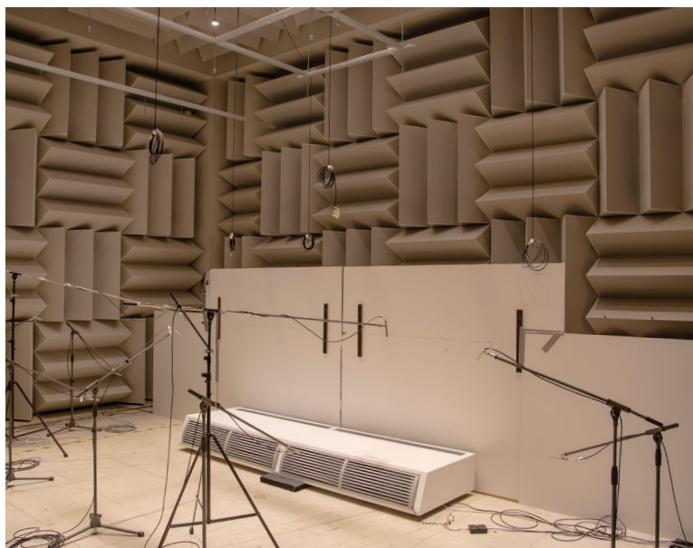
Kurtyna Tandem w laboratorium pomiarów akustycznych
