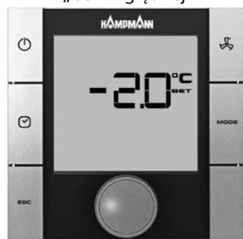
Parametr P36=1 Ustawianie wartości temperatury zadanej ± 3K
