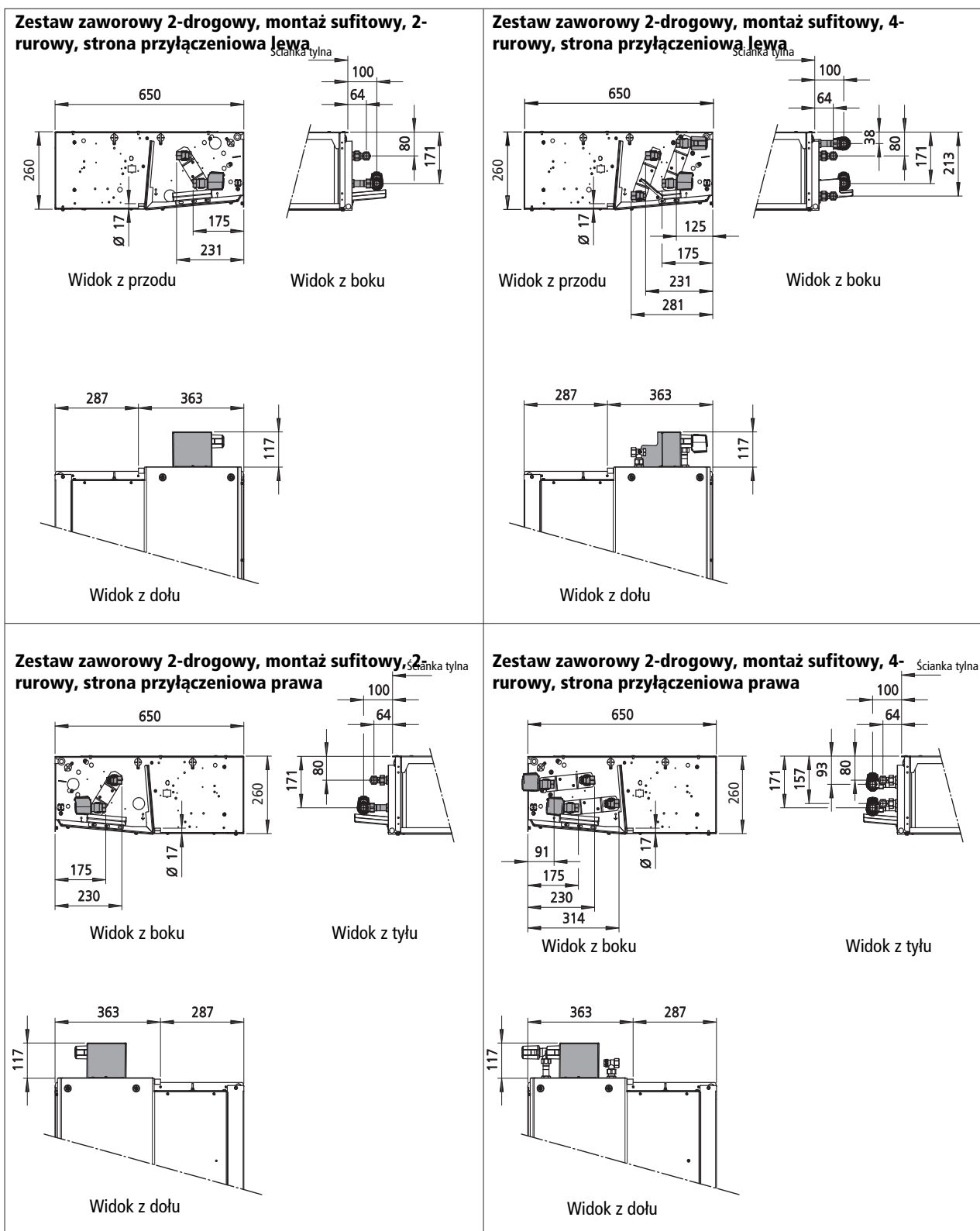
Rys. 12: Wymiary zestawu zaworowego 2-drogowego (wersja sufitowa)
