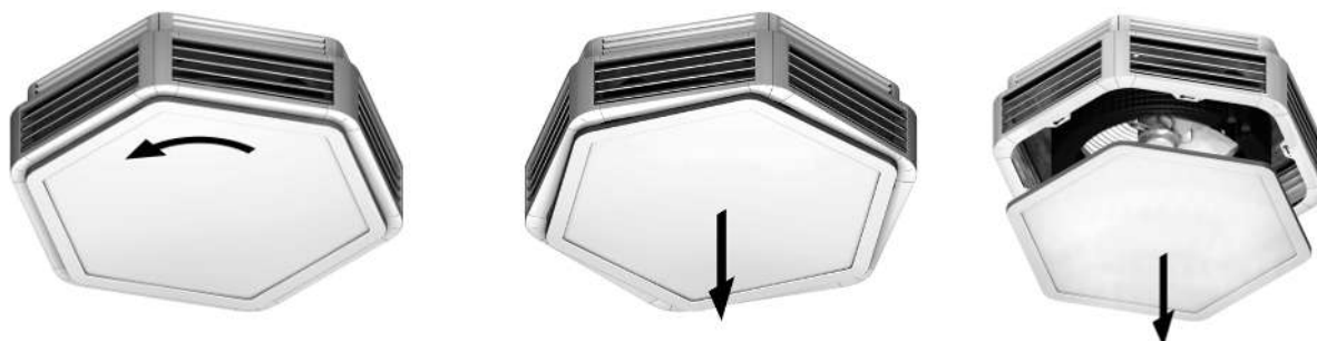
Rys. 12: Demontaż pokrywy obudowy
